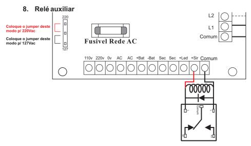
O relé auxiliar **não acompanha** a central, porém pode ser adaptável qualquer relé de contato seco desde que a tensão de alimentação seja compatível com a central (12Vdc). Aconselhamos ligar a bobina do relé na saída da sirene, sendo assim quando a central acionar, o relé auxiliar acionará também. O relé pode ser utilizado para acionamento de outras centrais, lâmpadas indicadoras, exaustores entre outros dispositivos.
