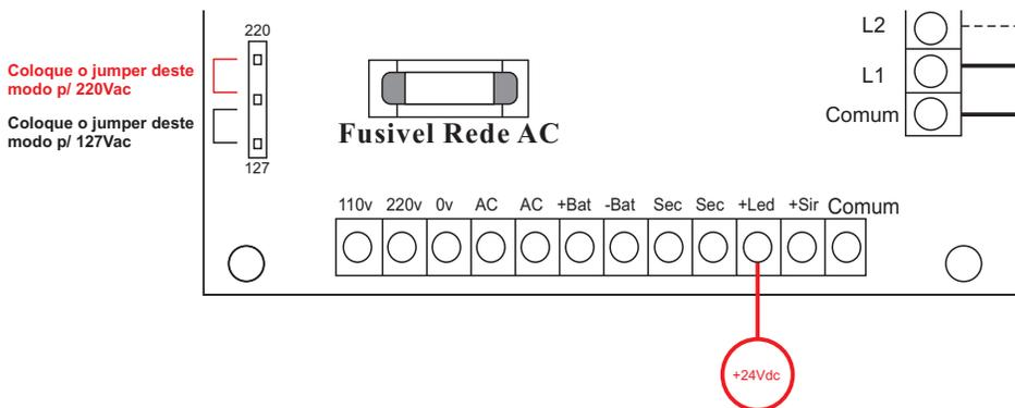
O borne +Led é um ponto de alimentação comutado pela chave geral da central, destinado somente à ligação de acessórios relacionados ao sistema de alarme de incêndio como botoeiras 3 fios, detectores com relé 3 fios e central repetidora de alarme, sendo todos estes equipamentos Majuss. Este borne está limitado a uma corrente máxima de 400mA.
