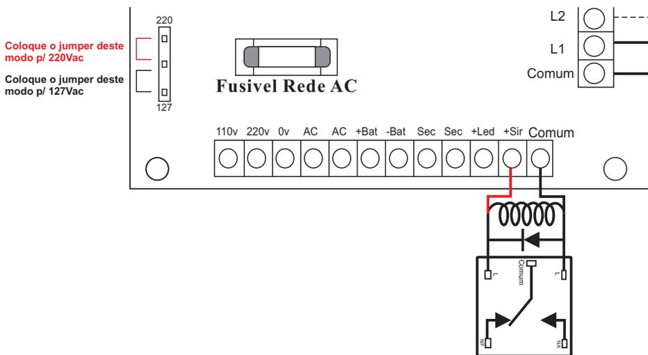
O relé auxiliar **não acompanha** a central, porém pode ser adaptável qualquer relé de contato seco desde que a tensão de alimentação seja compatível com a central (24Vdc). Aconselhamos ligar a bobina do relé na saída da sirene, sendo assim quando a central acionar, o relé auxiliar acionará também. O relé pode ser utilizado para acionamento de outras centrais, lâmpadas indicadoras exaustores, entre outros dispositivos.
